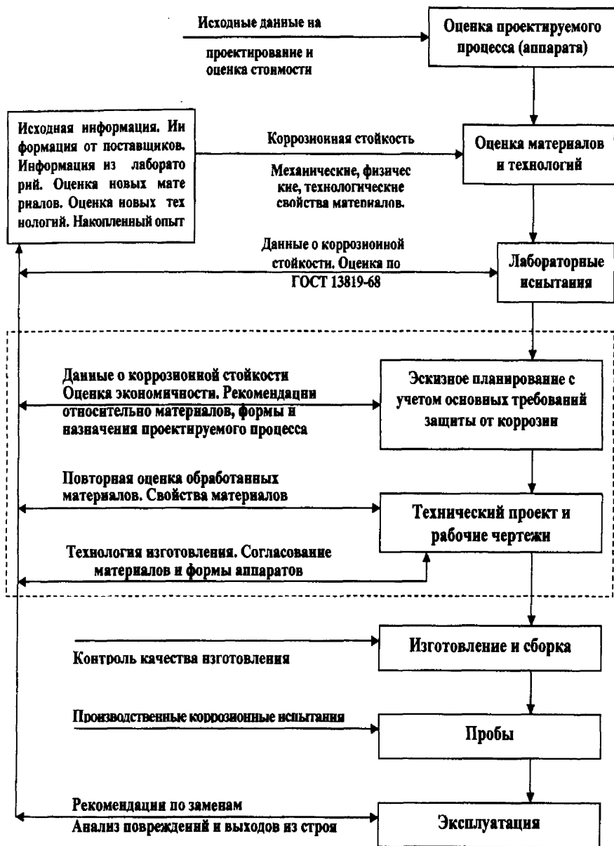
Рис. 11. Схема мероприятий по защите от коррозии при проектировании
