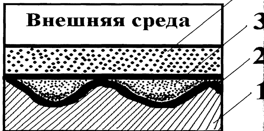
Рис. 82. Схема строения лакокрасочного покрытия: 1 — металл, 2 — слой грунта, 3 — шпаклевка, 4 — слой эмали
