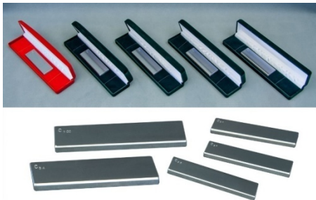
Контрольный образец для капиллярной дефектоскопии
