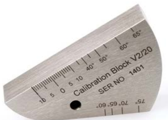
СО V2 для настройки дефектоскопов при УЗ-контроле
