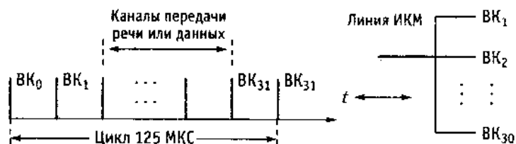
42 сурет. Импульсті-кодты модуляциялы (ИКМ) тасымалдау жүйелерінің орталықтарының (ЦСП) циклдары және арналардың уақыт бойынша жіктелуінің схематикалық кескіні.
